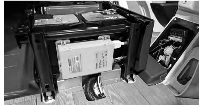
Fahrzeugelektrik unter dem Beifahrersitz
