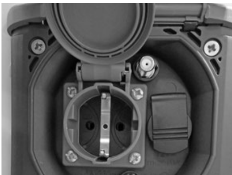
Vorzelt-Außensteckdose mit Antennenanschluss
