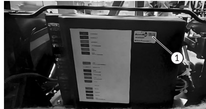
Zentralsteuerung mit QR-Code
