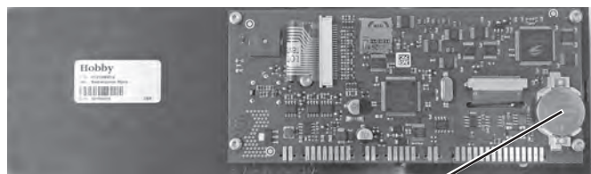
Lado posterior de la placa de circuitos impresos en el display TFT
