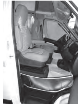
Aislamiento del espacio reposapiés en la cabina del conductor
