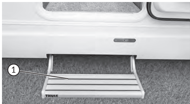
Peldaño de acceso extendido
