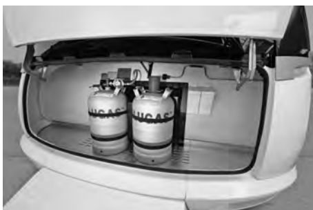
Positionering av gasflaskan i gasolkoffert
