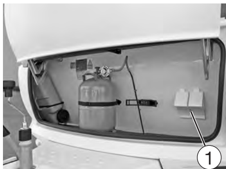
Underläggskilar i gasolkoffert
