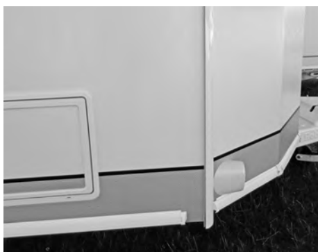
Förtältlist med kederindrag nedifrån
