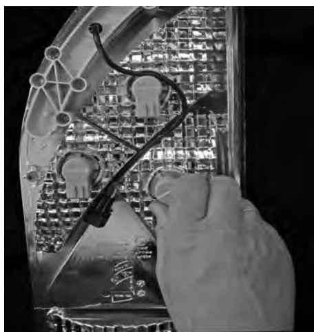
Skruva ut glödlampor ur fattningen
