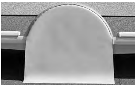
Skärmkant med integrerad kederlist för hjulkåpa
