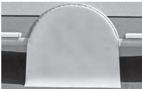
Skärmkant med integrerad kederlist för hjulkåpa
