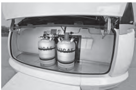
Positionering av gasflaskan i gasolkoffert
