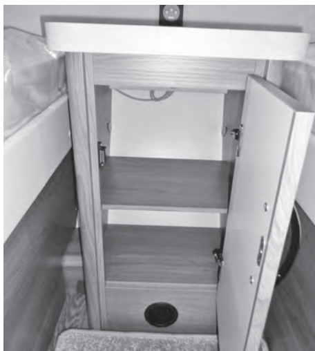
Dörr med magnetlås
