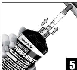
Skjut på påfyllningsslangen på däckventilen
