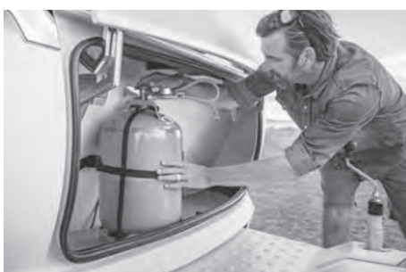
Positionering av gasflaskan i gasolkoffert
