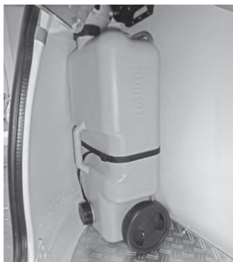
Avloppstank i gaslokkoffert
